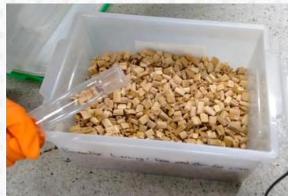
(ข) นำผักตบชวาแช่สารละลาย (NaOH) 5% w/v
