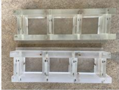
(ก) เตรียมแบบหล่อขนาด 5x5x5 ซม.
