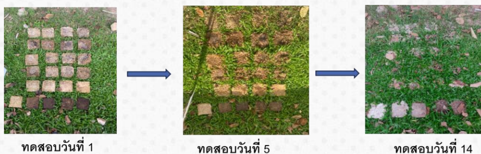
รูปที่ 8. ผลการทดสอบประสิทธิภาพการนำแผ่นปุ๋ยไปคลุมหญ้าในระยะเวลา 14 วัน
