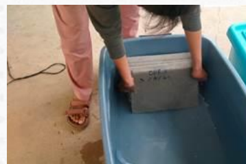
(ง) ขั้นตอนบ่มตัวอย่างแผ่นผนัง
