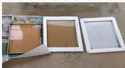
(ก) เตรียมแบบหล่อขนาด 30x30x1.0 ซม.
