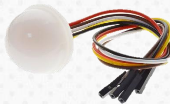
รูปที่ 12 เซนเซอร์วัดความสว่างแสง BH1750FVI
