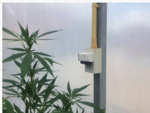
รูปที่ 16 ตำแหน่งเซนเซอร์วัดอุณหภูมิและความชื้นสัมพัทธ์
