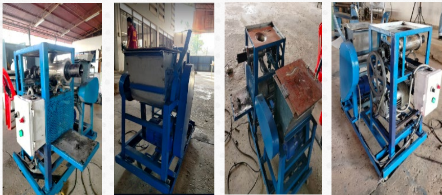
ภาพที่ 2 นวัตกรรมเครื่องอัดเชื้อเพลิงแท่งอเนกประสงค์
