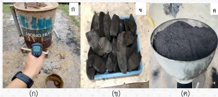
ภาพที่ 3 แสดงการเผาผลแยมะค่าโมง (ก), การเปลี่ยนแปลงสภาพของถ่านผลแยมะค่าโมงหลังการเผาไหม้ (ข), จากนั้นทำการบดให้ละเอียดหลังจากการเผาไหม้ (ค)
