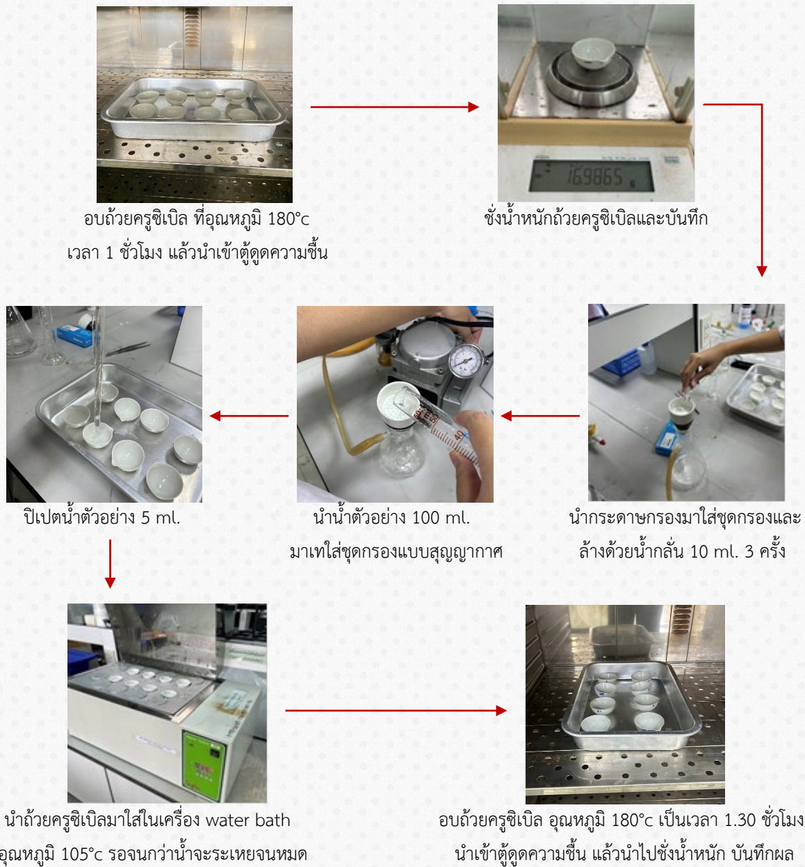
ภาพที่ 2 ขั้นตอนการวิเคราะห์ค่า TDS (Total dissolved solids)
