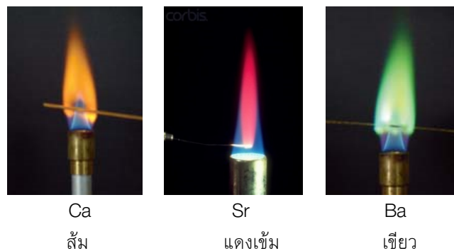
ภาพที่ 3.24 ลักษณะสีเปลวไฟของโลหะ Ca, Sr และ Ba
