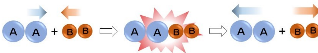
ภาพที่ 6.9 ลักษณะการชนกันของโมเลกุล A_2 และ B_2 (ก) การชนอย่างมีประสิทธิภาพ และ (ข) การชนอย่างไม่มีประสิทธิภาพ
