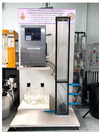
ภาพ 3.25 การต่อระบบดักจับโอโซนที่ไม่เข้าทำปฏิกิริยากับชุดถังทำปฏิกิริยา
