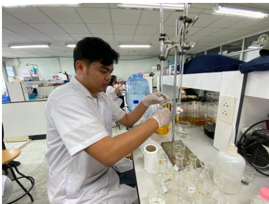
ภาพ 3.14 ขั้นตอนการไทเทรตตัวอย่างด้วยสารละลาย FAS ความเข้มข้น 0.25 N
