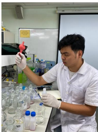
ภาพ 3.15 ขั้นตอนการเติมน้ำตัวอย่างลงในขวด BOD
