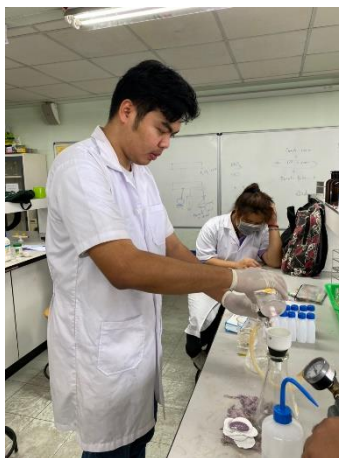
ภาพ 3.18 ขั้นตอนการกรองตัวอย่างเพื่อตรวจวิเคราะห์สี
