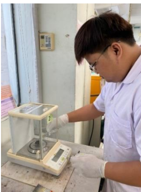
ภาพ 3.10 ขั้นตอนการชั่งน้ำหนักกระดาษกรอง
