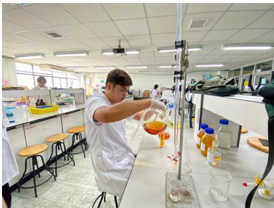
ภาพ 3.12 ขั้นตอนการไทเทรตหาปริมาณไอโชนในสารละลายโพแทสเซียมไอโอไดด์
