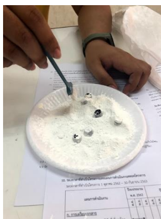
ภาพ 3.23 การเคลือบผิวตัวกลางพลาสติกด้วยไทเทเนียมไดออกไซด์
