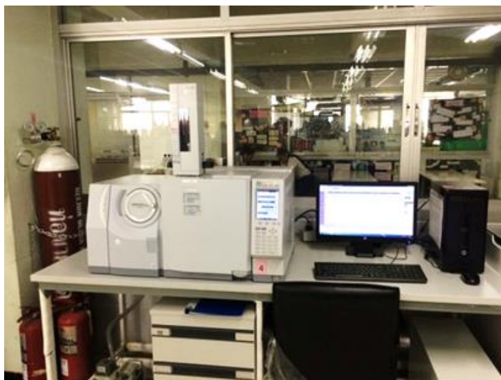
ภาพที่ 3.4 การวิเคราะห์สารตัวอย่างด้วยเครื่อง GC/MS QP2010 Ultra
