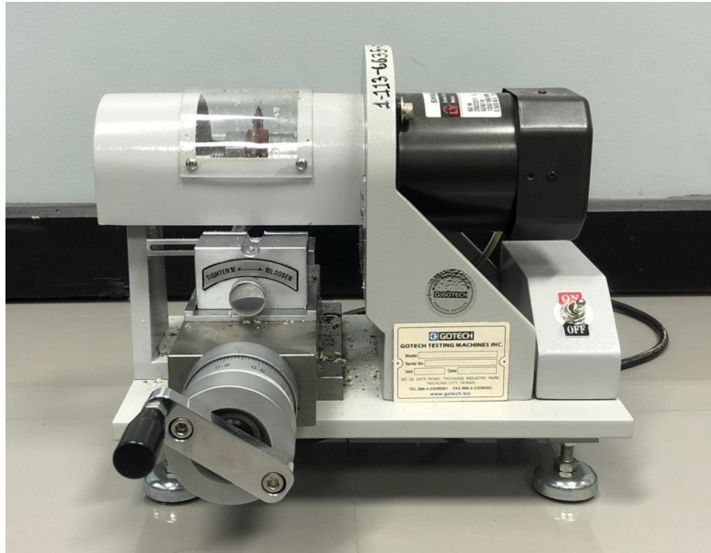
รูปที่ 20 เครื่องทำรอยบาก แบบ V notch ยี่ห้อ Gotech รุ่น GT-7016-A2
