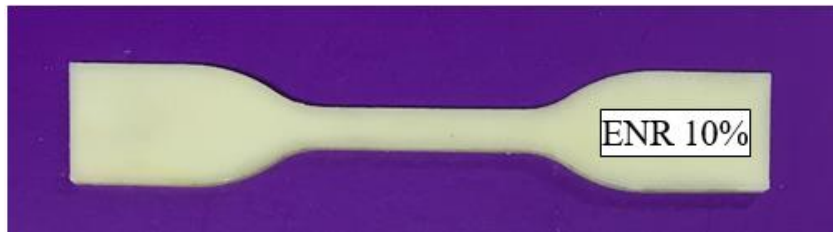
รูปที่ 18 ลักษณะของชิ้นงานทดสอบแรงดิ่งของ TPV ของพอลิแลกติกแอซิดที่มีการเติมยาง ENR ปริมาณต่างๆ กัน
