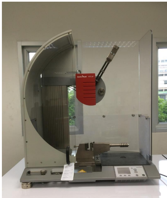
รูปที่ 21 เครื่องทดสอบแรงกระแทก ยี่ห้อ Zwick Roell รุ่น Hit5.5P
