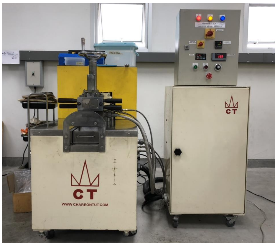
รูปที่ 13 เครื่องผสมแบบระบบปิด รุ่น MX75-TQ ของบริษัท เจริญทัศน์ จำกัด
