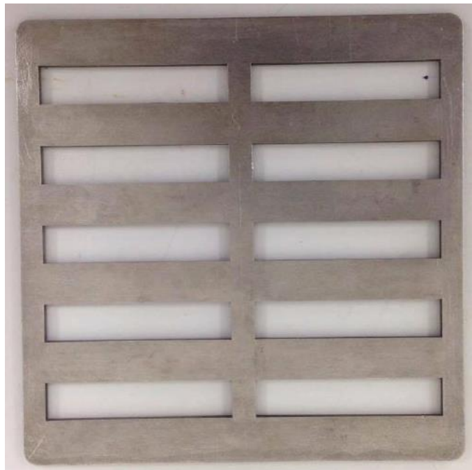
รูปที่ 16 ลักษณะของแม่พิมพ์ที่ใช้ในการเตรียมชิ้นงานทดสอบแรงกระแทก
