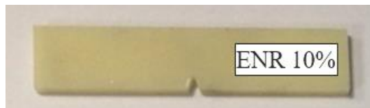
รูปที่ 19 ลักษณะของชิ้นงานทดสอบแรงกระแทกของ TPV ของพอลิแลกติกแอซิดที่มีการเติมยาง ENR ปริมาณต่างๆ กัน
