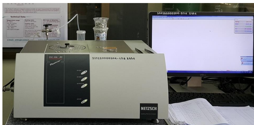
รูปที่ 22 เครื่อง Differential scanning calorimeter รุ่น DSC-204F1 ของบริษัท NETZSCH
