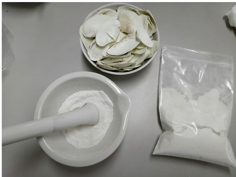
ภาพที่ 3.6 เปลือกหอยที่บดหยาบและบดละเอียดจนเป็นผงแคลเซียม
