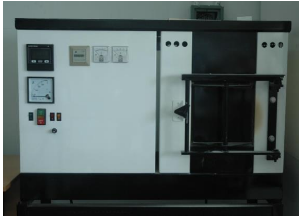
รูปที่ 3.4 เตาไฟฟ้าที่ใช้ในการหลอมแก้ว สามารถเผาได้อุณหภูมิสูงสุดถึง 1700 องศาเซลเซียส
