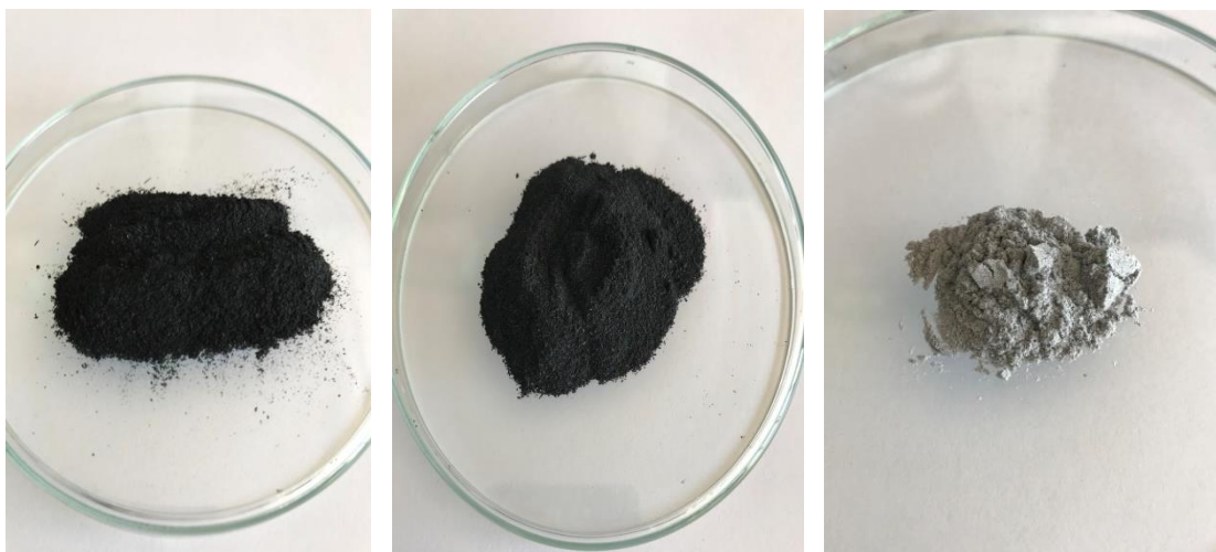
รูปที่ 4.2 แสดงผงแกลบที่ผ่านการเผาที่เงื่อนไขที่แตกต่างกัน ก.ผงแกลบที่อุณหภูมิ 1000°C ข.ผงแกลบที่อุณหภูมิ 1100°C ค.ผงแกลบที่อุณหภูมิ 1200°C
