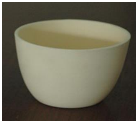
รูปที่ 3.6 เบ้าหลอมแก้วทนไฟที่ทำมาจากอะลูมินา (Alumina)
