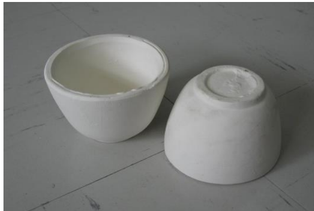
รูปที่ 3.5 เบ้าหลอมแก้วทนไฟที่ทำมาจากกระเบื้องขาว (porcelain)
