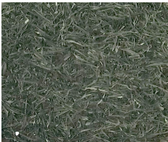
รูปที่ 4.1 แสดงผงแกลบที่ผ่านการเผาไล่สารอินทรีย์ที่อุณหภูมิ 1000°C
