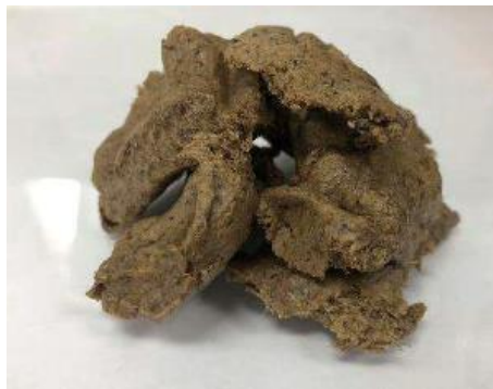
รูปที่ 3.6 ลักษณะของผสมกลุ่ดินและเส้นใยปาล์มที่มีการเติมกลีเซอรอลภายหลังการผสมด้วยเครื่องผสมระบบปิด
