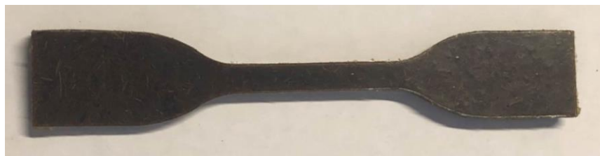
รูปที่ 3.11 ตัวอย่างชิ้นงานทดสอบแรงดึงวัสดุเชิงประกอบกลูเตนและเส้นใยปาล์มน้ำมัน
