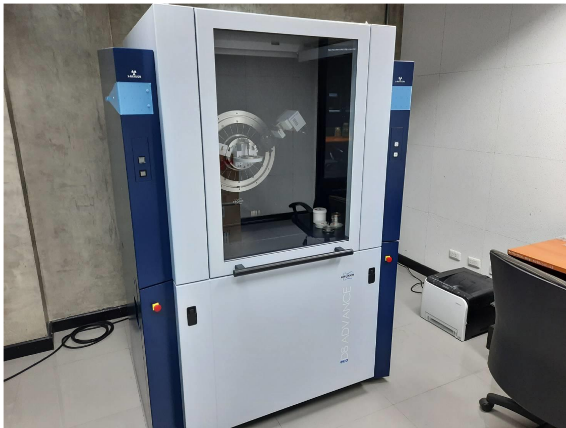
รูป 4 เครื่องวิเคราะห์การเลี้ยวเบนของรังสีเอกซ์ (X-Ray Diffractometer: XRD) จากบริษัท Bruker รุ่น D ADVANCE ECO
