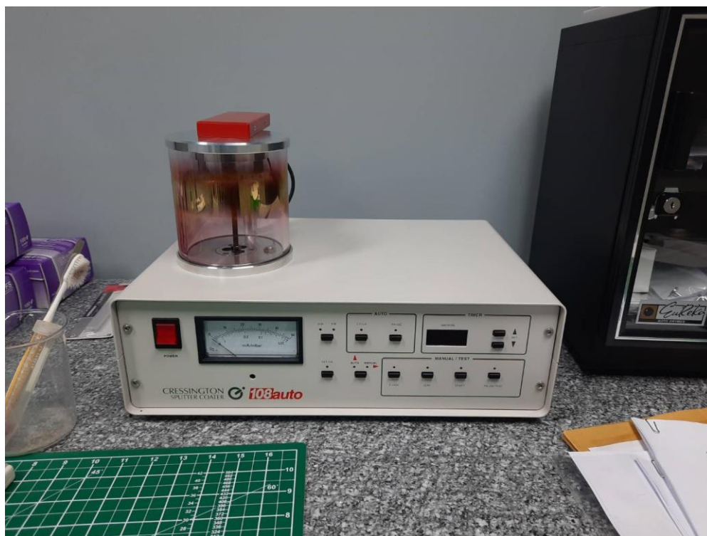
รูป 1 เครื่องเคลือบตัวอย่างด้วยฟิล์มบางแบบสปัตเตอร์ริง (Sputter Coater) จากบริษัท Cressington Scientific Instrument รุ่น Cressington 108auto
