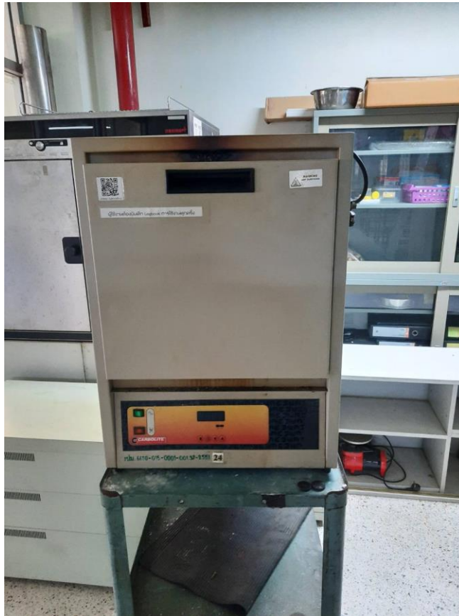
รูป 2 เตาอบ Carbolite ELF 11/14B Economy Chamber Furnace
