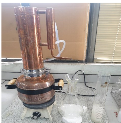
ภาพที่ 3 การติดตั้ง Alembic เพื่อทำการสกัดใบพลู
