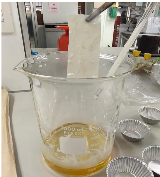
ภาพภาคผนวก ก6 ทดสอบการเคลือบกระดาษจากตอซังข้าวโพด ด้วยไขปาล์ม (Palm Wax)
