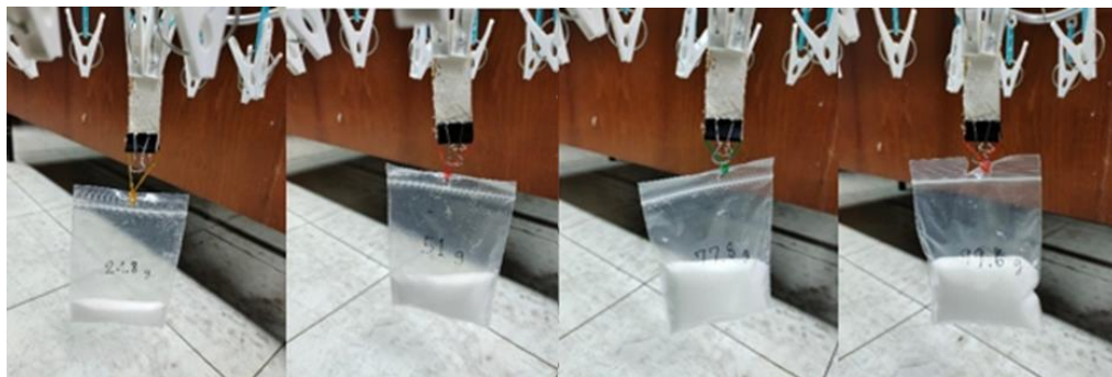
ภาพ 3.5 การทดสอบความต้านแรงฉีกขาดด้วยน้ำหนัก 25 50 75 และ 100 กรัม ตามลำดับ
