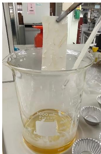
ภาพ 3.7 การเคลือบกระดาษด้วยไขปาล์ม (Palm Wax)
