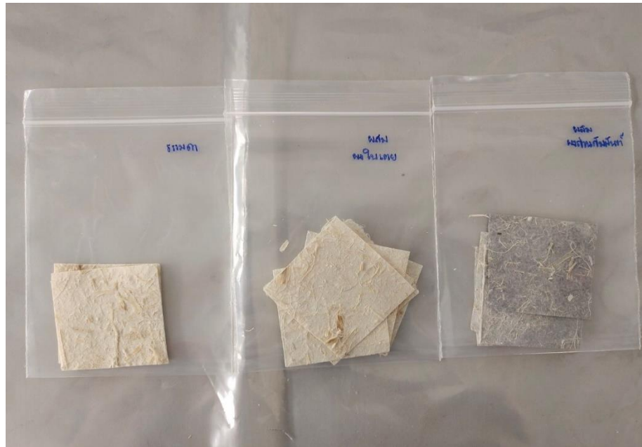
ภาพภาคผนวก ก2 การเตรียมตัวอย่างกระดาษจากตอซังข้าวโพดเข้าเครื่อง Scanning Electron Microscope
