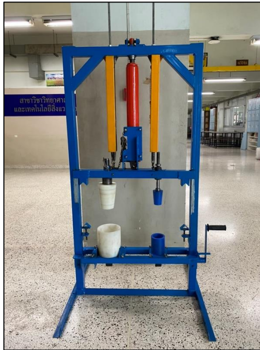
ภาพที่ 4.1 เครื่องอัดขึ้นรูปกระถางแบบไฮดรอลิกส์
