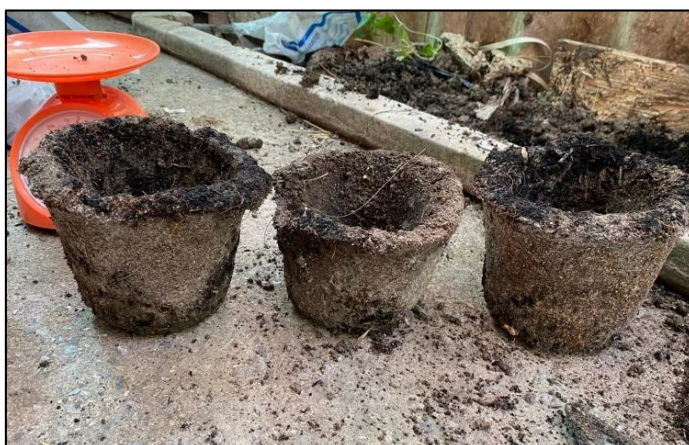
ภาพที่ 3.11 การทดสอบการย่อยสลายเมื่อผ่านไป 14 วัน
