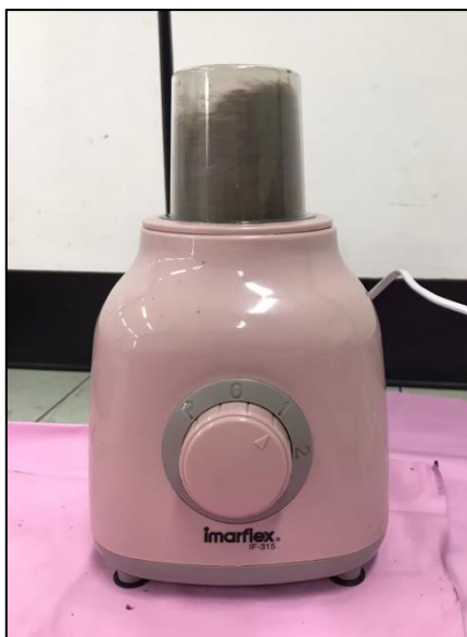
ภาพที่ 3.5 บดย่อยช่อดอกตัวผู้ของปาล์มน้ำมันด้วยเครื่องปั่น
