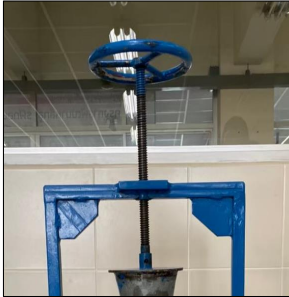
ภาพที่ 2.5 แบบหมุนมือของเครื่องอัดกระดาษ
