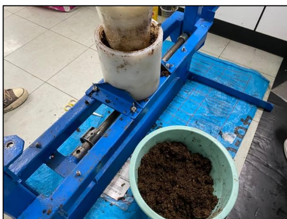
ภาพที่ 3.9 จากนั้นเข้าสู่กระบวนการขึ้นรูปโดยใช้เครื่องอัดกระถาง
