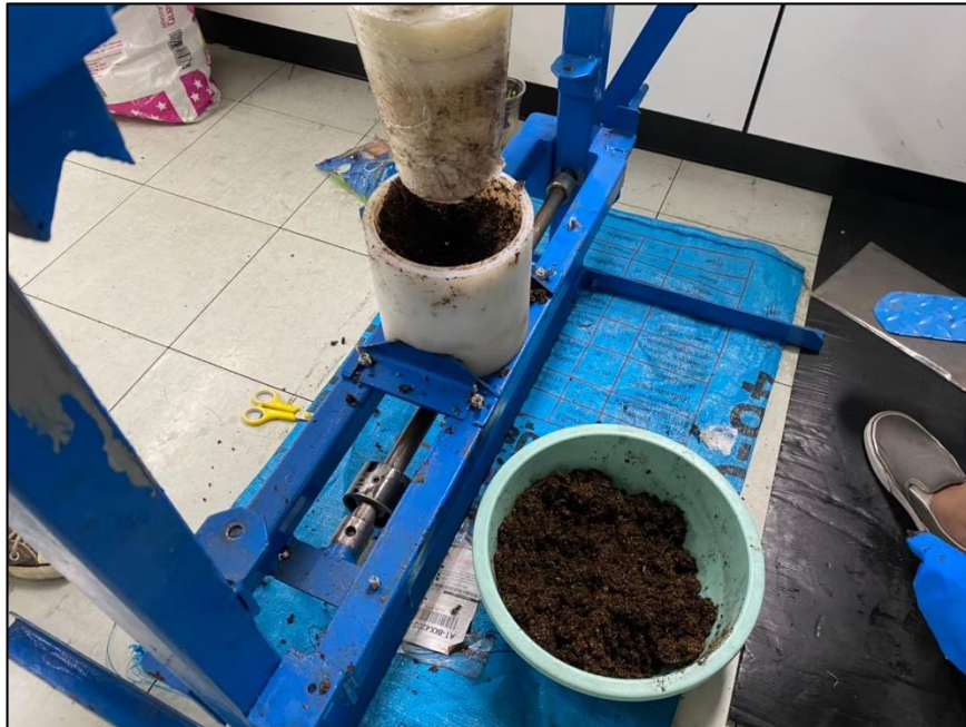
ภาคผนวกที่ ข7 นำส่วนผสมที่เข้ากันแล้วมาอัดขึ้นรูปกระถาง
