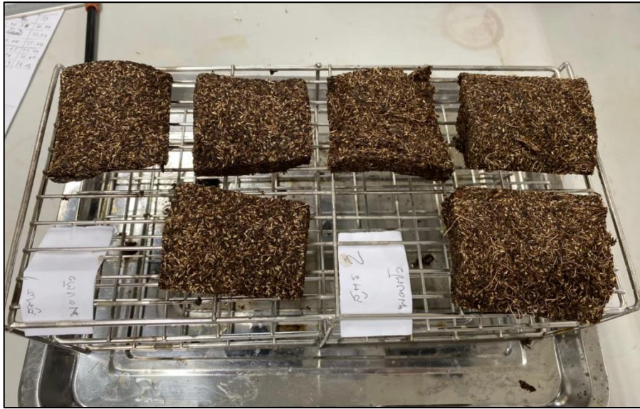
ภาคผนวกที่ ข11 ชิ้นส่วนกระถางในการทดสอบความpongตัวของกระถาง
