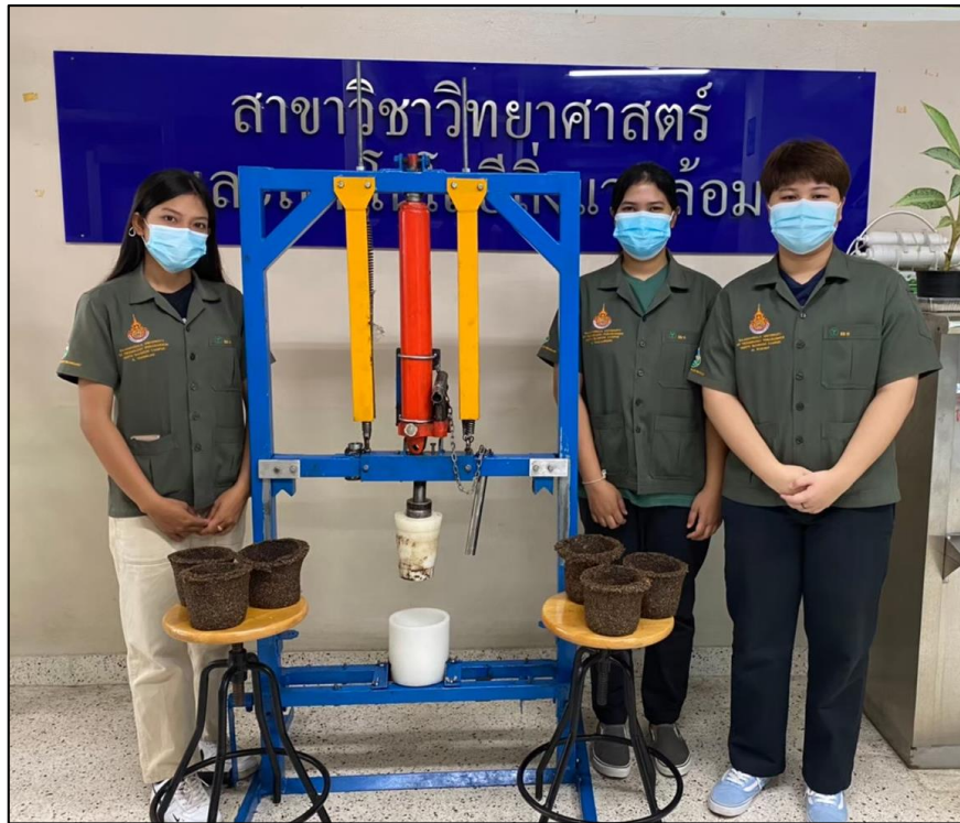
ภาคผนวกที่ ข9 เครื่องอัดขึ้นรูปกระถางและกระถางต้นไม้จากขี้ดอกตัวผู้ของปาล์มน้ำมัน
