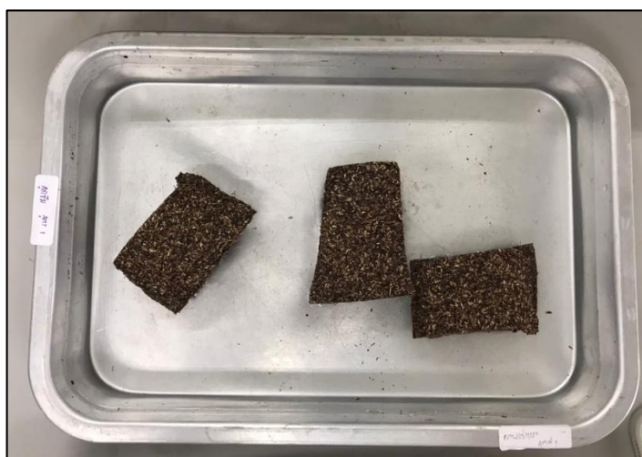
ภาพที่ 3.13 ชั้นทดสอบที่แช่น้ำสะอาด
