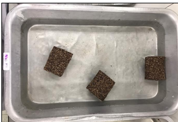
ภาพที่ 3.12 ชิ้นทดสอบที่แช่น้ำสะอาด
