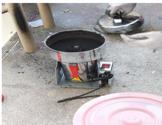
รูปที่ 13 เครื่องบดเกลบสูกีสีดำให้ละเอียด
