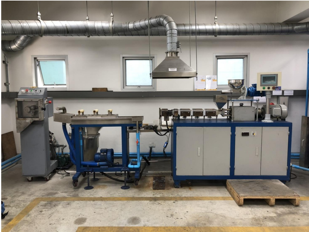
รูปที่ 3.4 เครื่องอัดรีดแบบเกลียวหนอนคู่ แบบหมุนไปทางเดียวกัน ยี่ห้อ Xinda รุ่น SHJ-20 จากบริษัท Enmach จำกัด
