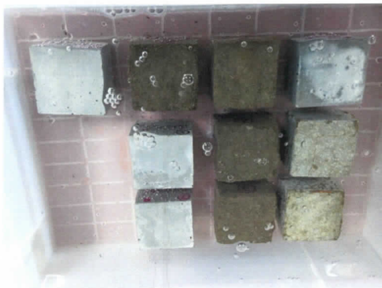
รูปภาพที่ 3.7 ขั้นตอนการวิเคราะห์ค่าการดูดซึมน้ำของชิ้นงานต้นแบบฯ
