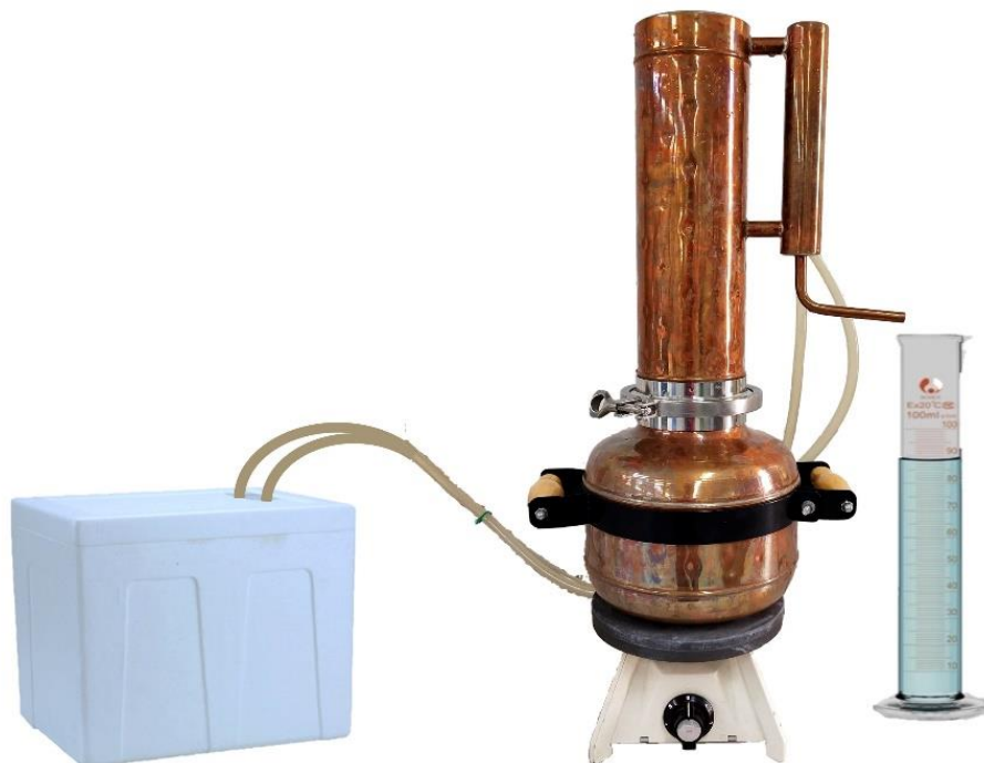
ภาพที่ 3.3 การเตรียมน้ำสกัดน้ำมันหอมระเหยจากใบชา (ภาพโดย วรวิทย์ จันทร์สุวรรณ, 2564)
