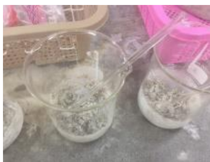
ภาพที่ 3 การผสมขยะพลาสติกกับน้ำยางพาราตามอัตราส่วนที่กำหนด
