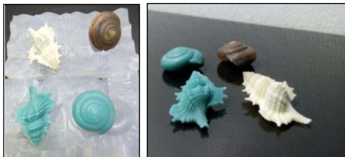
ภาพที่ 4 เทียนต้นแบบ (ก) การแกะเทียนต้นแบบออกจากพิมพ์ยางซิลิโคน (ข) ลักษณะเทียนต้นแบบที่ได้
