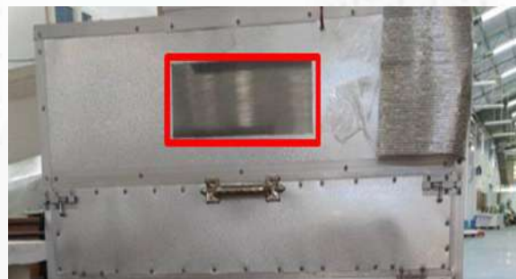
ภาพที่ 3 รูปบริเวณที่ติดตั้งหลอดฮีทเตอร์อินฟราเรด
