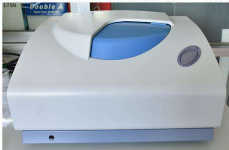
รูปที่ 4 Particle Size Analyzer ยี่ห้อ Horiba รุ่น SZ-100 [11]
