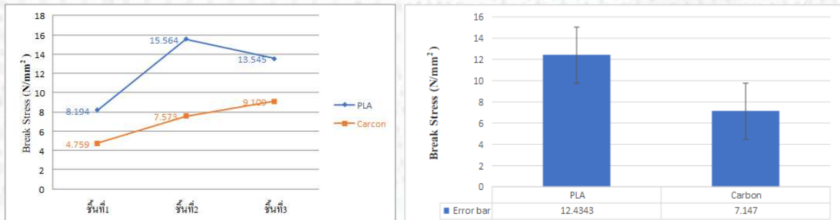
รูปที่ 21 กราฟแสดงผลการทดสอบวัสดุทั้ง 2 ชนิด โดยทำการทดสอบด้วยเครื่อง Tensile ได้ค่าของ Break Stress
