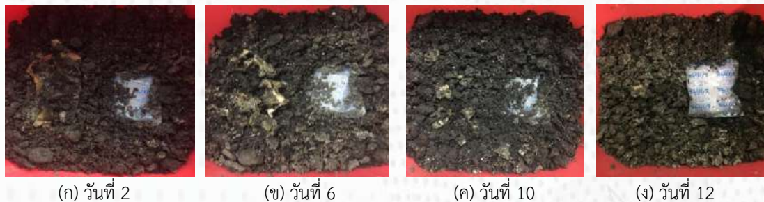
ภาพ 5 การย่อยสลายของผลิตภัณฑ์ของเส้นใยเปลือกข้าวโพดเคลือบสารสกัดน้ำมันผิวมะกรูด และของพลาสติก (ตัวควบคุม)
