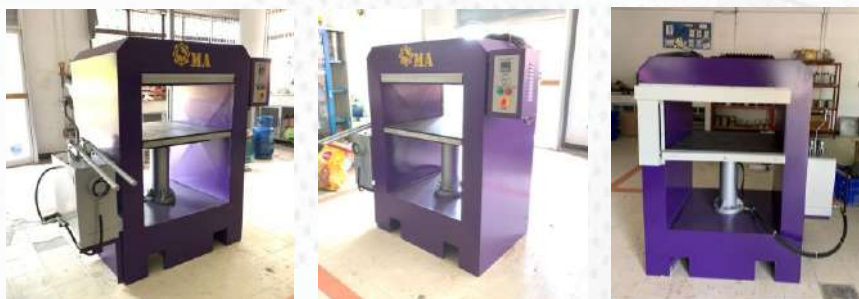
ภาพที่ 3 เครื่องอัดร้อนต้นทุนต่ำสำหรับชุมชนใช้ไฮดรอลิกแบบมือโยก
