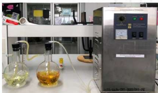
ภาพ 3.4 การทดลองหาปริมาณโอโซน (Ozone) ที่ผลิตจากเครื่องผลิตโอโซน
