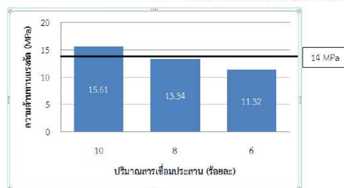
รูปที่ 11 ความต้านทานแรงดัดของแผ่นอัดจากเศษไม้สักที่ปริมาณสารเชื่อมประสานต่าง ๆ
