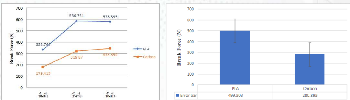
รูปที่ 20 กราฟแสดงผลการทดสอบวัสดุทั้ง 2 ชนิด โดยทำการทดสอบด้วยเครื่อง Tensile ได้ค่าของ Break Force
