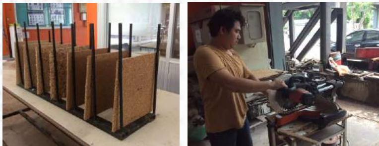
ภาพที่ 7 การฝั่งแผ่นอัดจากเศษไม้สักและตัดขอบแผ่น
