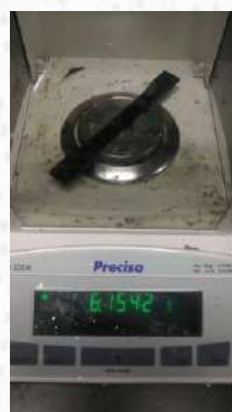
รูปที่ 10 การเปรียบเทียบน้ำหนักของเส้นใยคาร์บอนและพลาสติก ชนิด PLA
