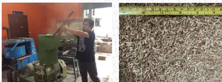
ภาพที่ 2 การบดย่อยเศษไม้สีกและเศษไม้สีกที่ผ่านการบดย่อยแล้วผ่านตะแกรงขนาด 10 มม.
