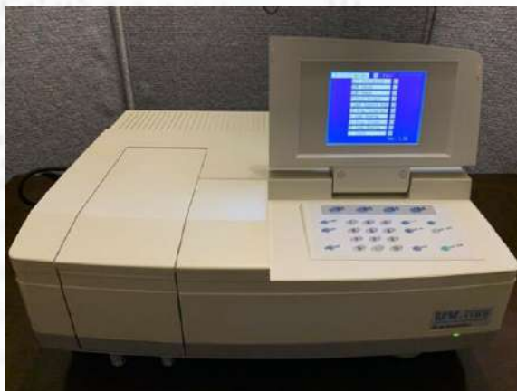
รูปที่ 5 Ultraviolet-visible spectroscopy (UV-Vis) ยี่ห้อ Shimadzu รุ่น UV-1700 [3]
