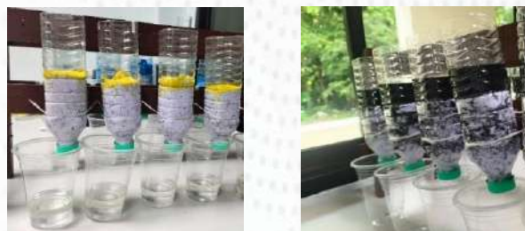
ภาพที่ 5 ตัวอย่างลักษณะการดูดซับสีของชุดดูดซับสีของน้ำเสีย
