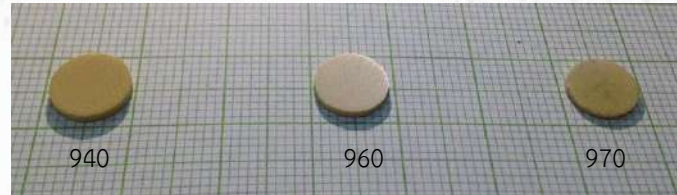
ภาพที่ 3.1 เซรามิก BSNT-BT x=0.04 ณ อุณหภูมิ 940, 960 และ 970 องศาเซลเซียส
