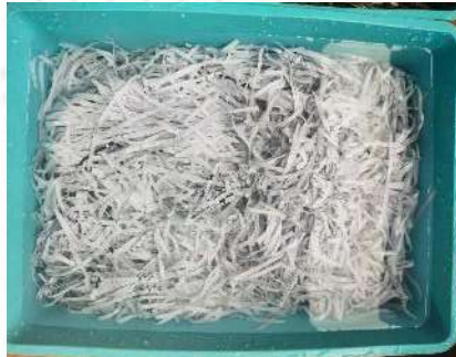
ภาพที่ 1 การแช่กระดาษเหลือใช้สำนักงานในน้ำเพื่อเตรียมชุดดูดซับสีของน้ำเสีย
