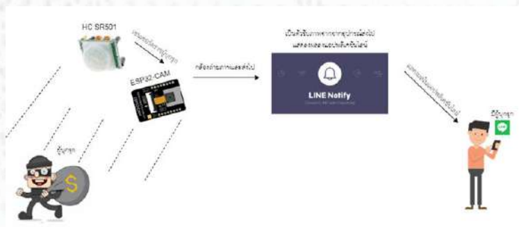
ภาพที่ 3 แสดงขั้นตอนการทำงานของผังระบบแจ้งเตือนผู้บุกรุกผ่านแอปพลิเคชันไลน์
