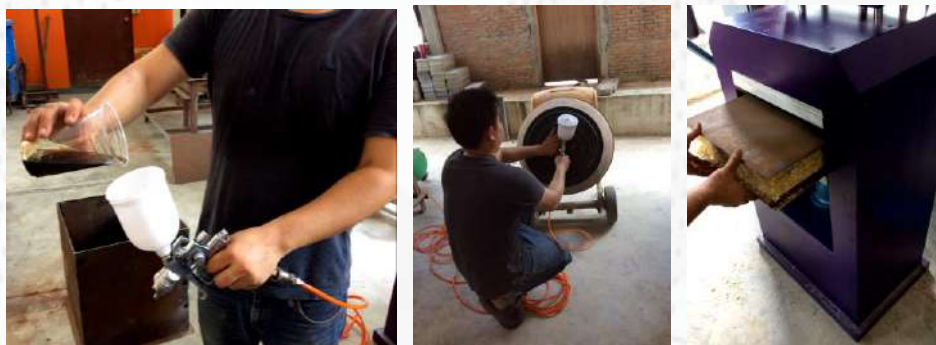
ภาพที่ 6 กระบวนการอัดขึ้นรูปแผ่นอัดจากเศษไม้สัก
