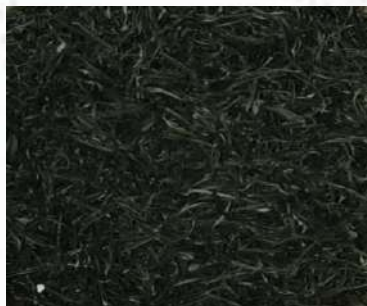
รูปที่ 3.1 แสดงผงแกลบที่ผ่านการเผาที่อุณหภูมิ 1000°C ช่วงแรก จากกล้อง OM
