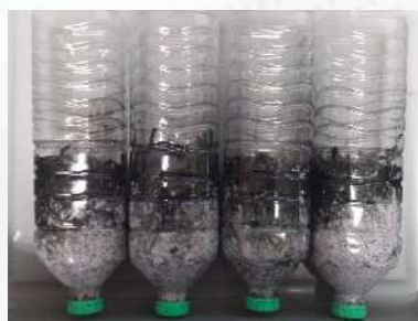
ภาพที่ 7 ลักษณะการดูดซับของสีย้อมผ้าบนกระดาษเหลือใช้ในสำนักงาน
