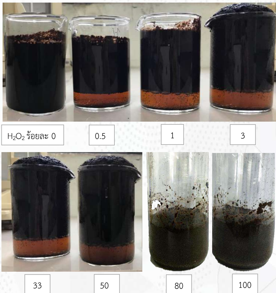
ภาพ 4 การกำจัดไขมันจากกากกาแฟชนิด A ด้วยสารละลาย H_2O_2 ที่ความเข้มข้นต่าง ๆ
