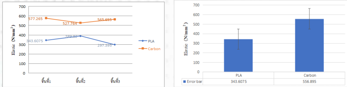
รูปที่ 19 กราฟแสดงผลการทดสอบวัสดุทั้ง 2 ชนิด โดยทำการทดสอบด้วยเครื่อง Tensile ได้ค่าทดสอบของElastic
