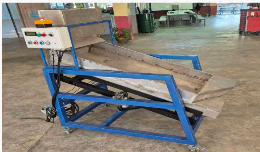
ภาพที่ 9 มุมตะแกรงร่อนที่ 25 องศา เทียบกับแนวระนาบ
