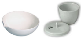
ถ้วยระเหย (evaporating disk) ใช้ระเหยสารด้วยความร้อน
