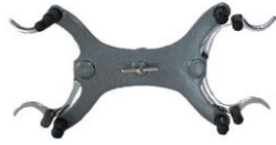
ที่จับบิวเรต (buret clamp) ใช้จับบิวเรตในการทำการไทเทรต ใช้ร่วมกับขาตั้ง (stand)
