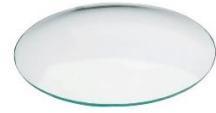
กระจกนาฬิกา ใช้ปิดปากบีกเกอร์ ใช้รองรับวัสดุที่ร้อน และอื่นๆ
