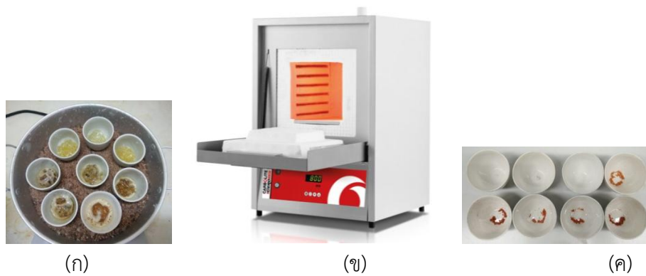
ภาพที่ 1.40 การเผาตัวอย่างในเตาเผา (ก) ตัวอย่างทำการระเหยตัวทำลาย (ข) เผาด้วยเตาเผา และ (ค) ส่วนที่เหลือจากการเผา
